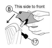
FIG 3. INSTALLING THE SHARPENER BOX
